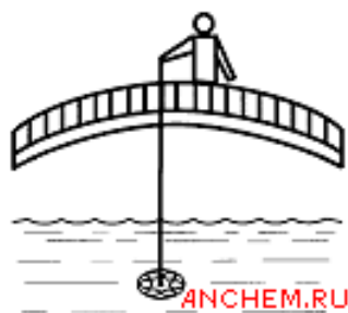
Рис. 1. Диск Секки для определения мутности воды.
