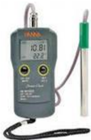
Рис. 4а. HI 8314 портативный многоцелевой прибор для точного измерения pH, мВ и температуры
