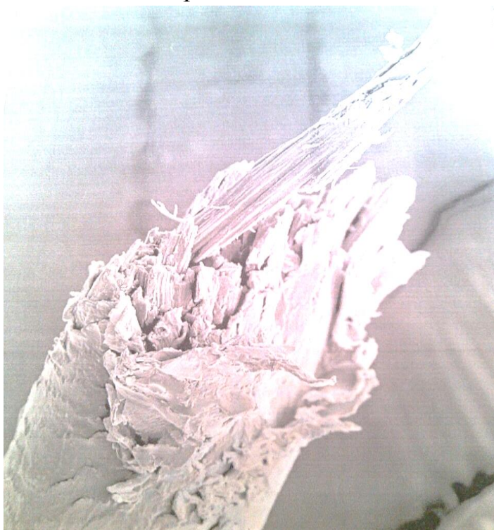
Рис. 21. Размозжение концов волоса при волочении
