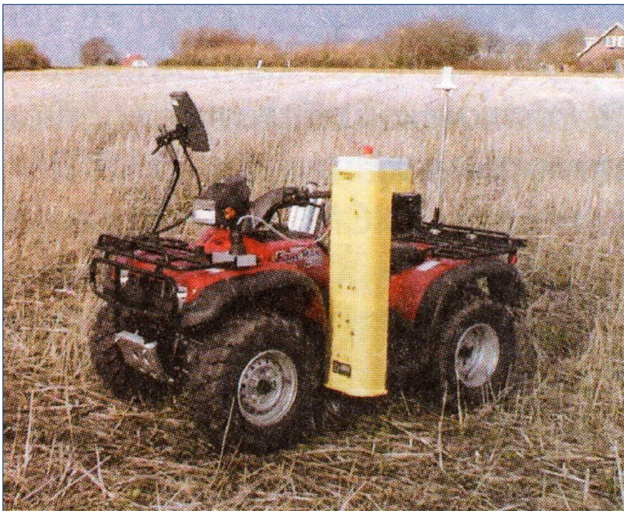
Рис. 41. Автоматический пробоотборник на базе мотоциклетного транспортного средства
