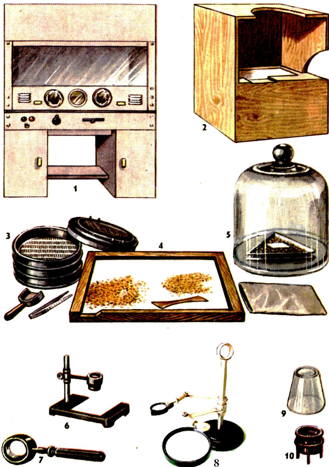
Рис. 7. Приборы и инвентарь, применяемые при определении чистоты семян: 1 – вытяжной шкаф; 2 – диафаноскоп; 3 – набор лабораторных решет; 4 – разборная доска и шпатель; 5 – розетки (под стеклянным колпаком); 6, 7, 8, 9, 10 – лабораторные луны
