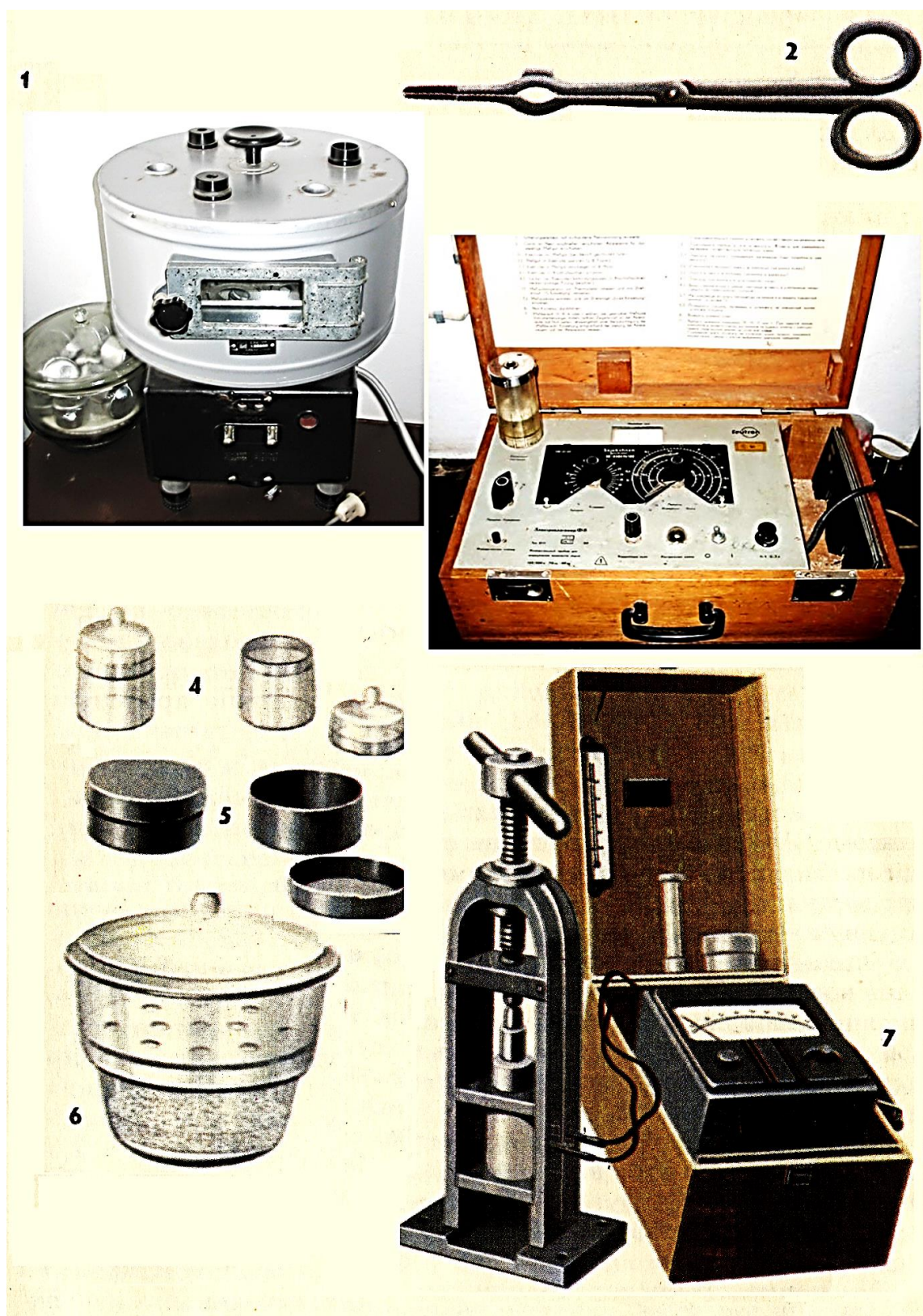
Рис. 14. Приборы и инвентарь, применяемые при определении влажности семян: 1 – сушильный шкаф СЭШ-3; 2 – тигельные щипцы; 3 – влагомер «гигрорекод» Ф-8; 4 – бюксы стеклянные; 5 – бюксы металлические; 6 – эксикатор с хлористым кальцием; 7 – электровлагомер ВЭ-2М
