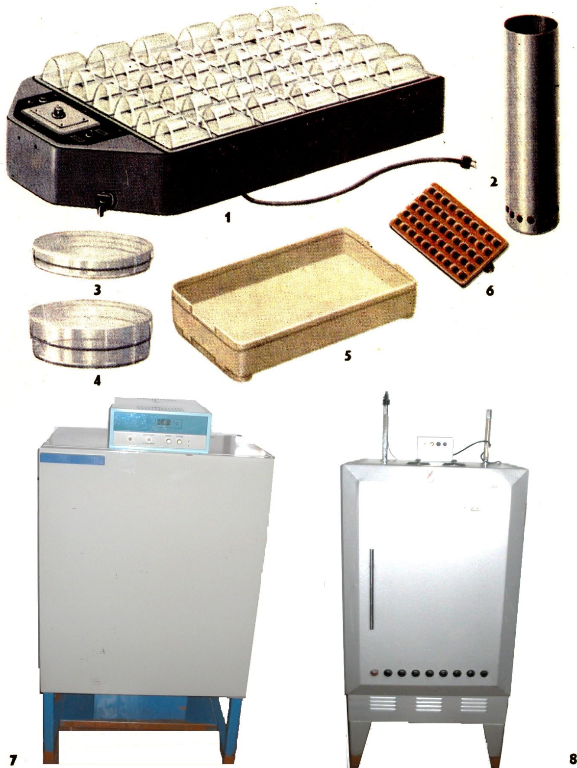
Рис. 9. Приборы и инвентарь, применяемые при определении всхожести семян: 1 – открытая растильня; 2 – цилиндр для определения влагоемкости песка; 3 – чашка Петри; 4 – чашка Коха; 5 – растильня; 6 – маркер для посадки семян; 7 – термостат-холодильник ТГУ-020-200; 8 – термостат ТПС-3
