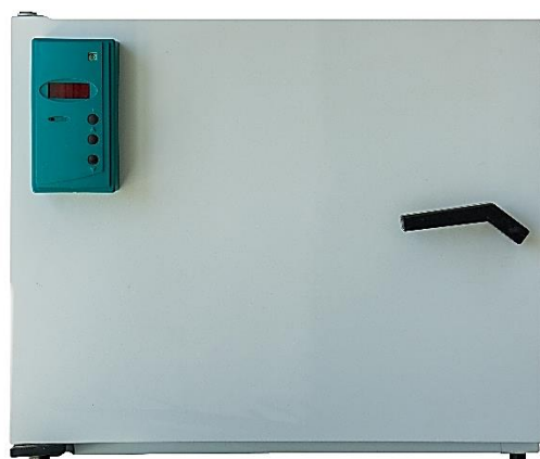
Рис.15. Приборы, применяемые при определении влажности семян: 1 – электромельница ЛЗМ; 2 – автоматизированная воздушно-тепловая установка для измерения влажности зерна и зернопродуктов; 3- шкаф сушильный; 4 – влагомер
