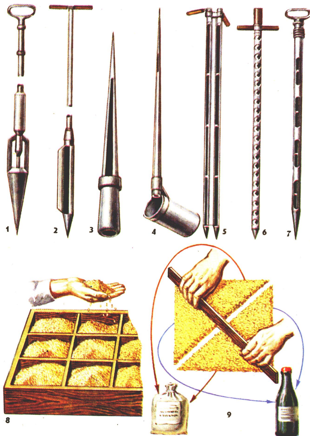
Рис. 1. Щупы (пробоотборники): 1 – конусный; 2 – ПЗ-3; 3 – мешочный; 4 – клеверный; 5 – ПЗ-2; 6 и 7 – цилиндрический; 8 – просмотр выемок для установления однородности семян; 9 – выделение средних образцов из исходного в мешочек и в бутылку.
