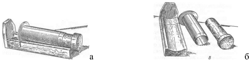
Рис. 1. Пробник Журавлева для определения пористости хлеба:
