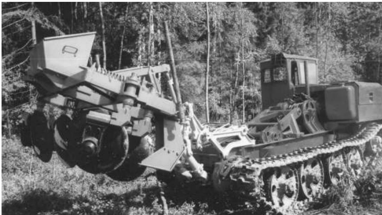
Рисунок 4.11 – Плуг дисковый для вырубок ПДВ-1,5
