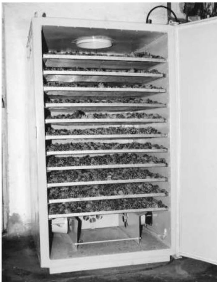
Рисунок 2.13 – Малогабаритная шишкосушилка СМ-45
