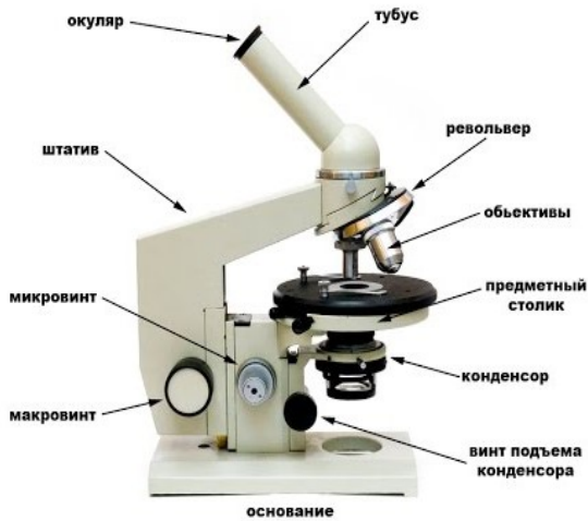
Рисунок 1 – Устройство микроскопа
