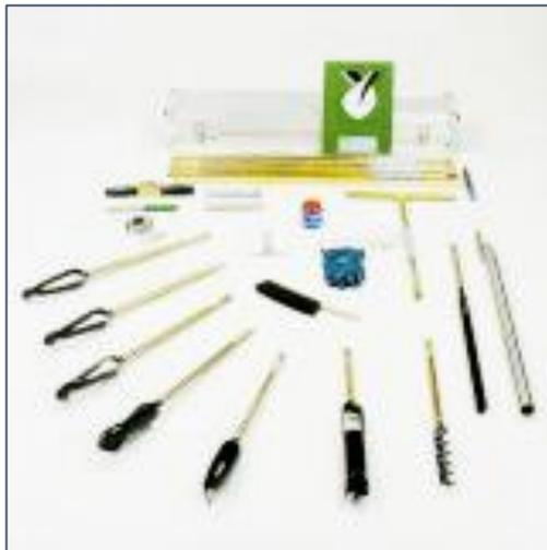
**Рис. 6. Набор почвенных буров Эдельмана Р 1.01 для почв на глубине до 8-10 метров**
