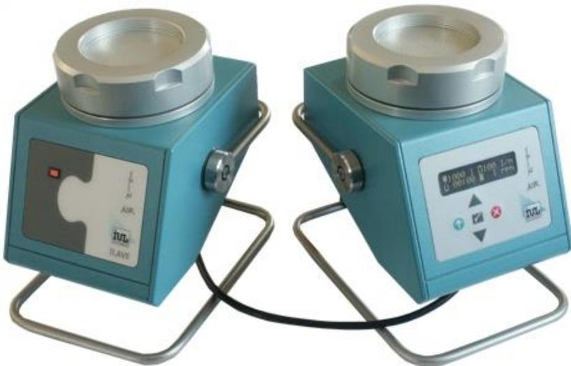
**Рис. 3. Пробоотборник воздуха Spin Air**
