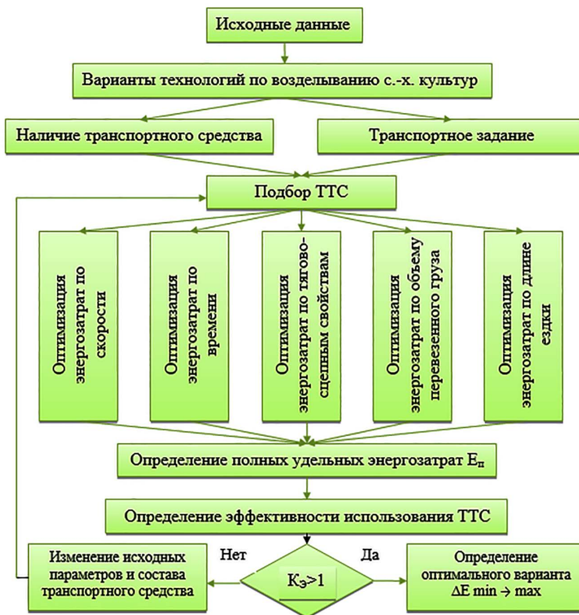
Рисунок 23 – Блок-схема определения эффективности использования транспортно-технологических средств
