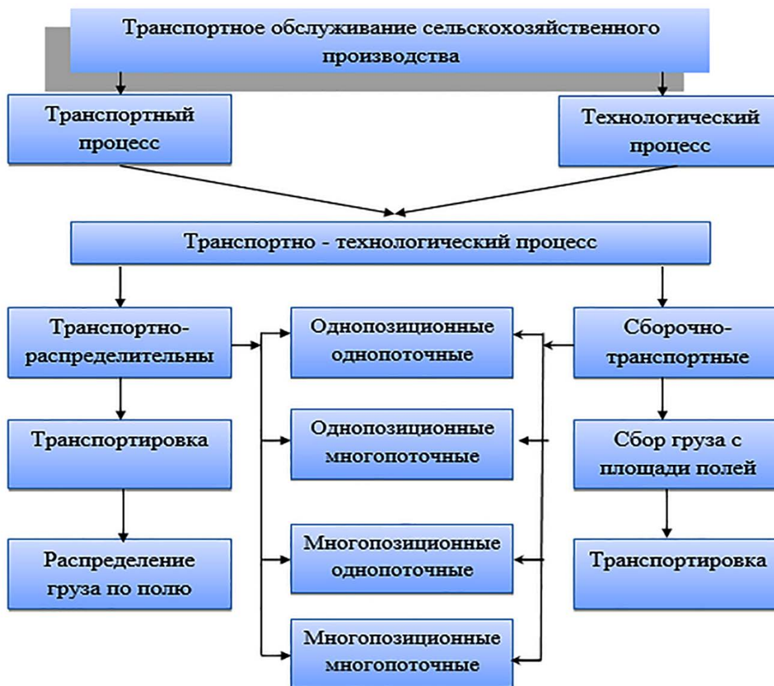
Рисунок 22 – Классификация транспортно-технологических процессов обработки зерна
