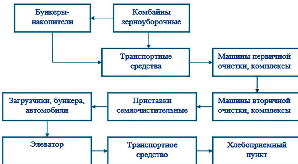
Рисунок 21 – Технологическая поточная линия уборки, перевозки и послеуборочной обработки зерна
