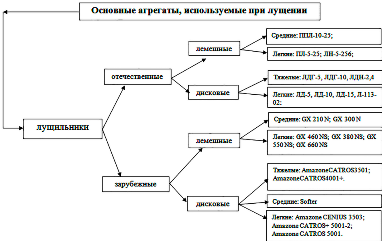
Рисунок 14 – Основные агрегаты, используемые при лущении
