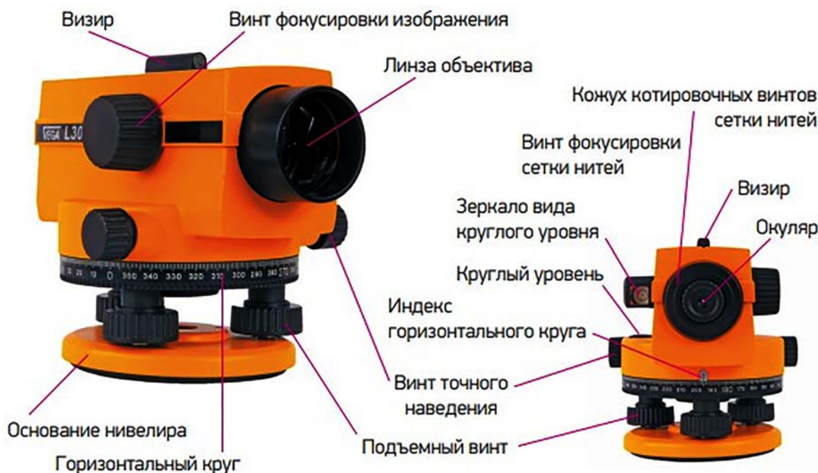
Рисунок 10 – Устройство нивелира VEGA L30
