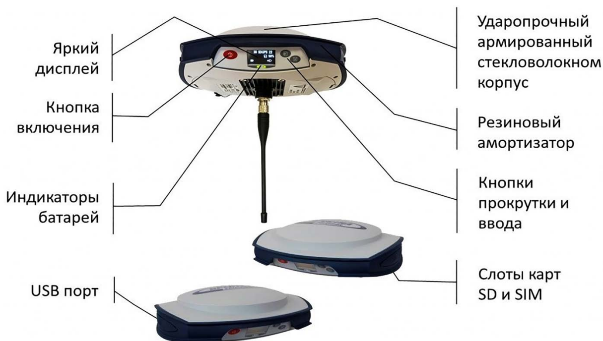
Рисунок 16 – Устройство ГНСС приемника
