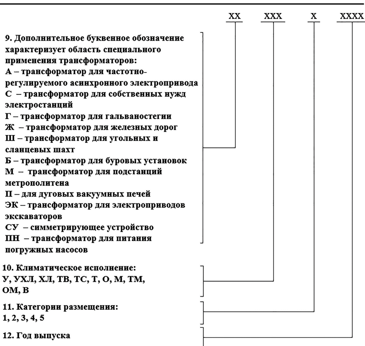
Рисунок 1.17 – Структурная схема условного обозначения типа трансформатора
