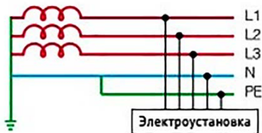
Рисунок 4.5 – Система TN-C-S переменного тока при однофазном и трехфазном электроприемниках
