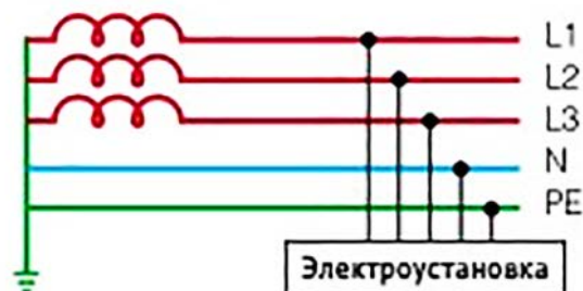
Рисунок 4.4 – Система TN-S переменного тока при однофазном и трехфазном электроприемниках
