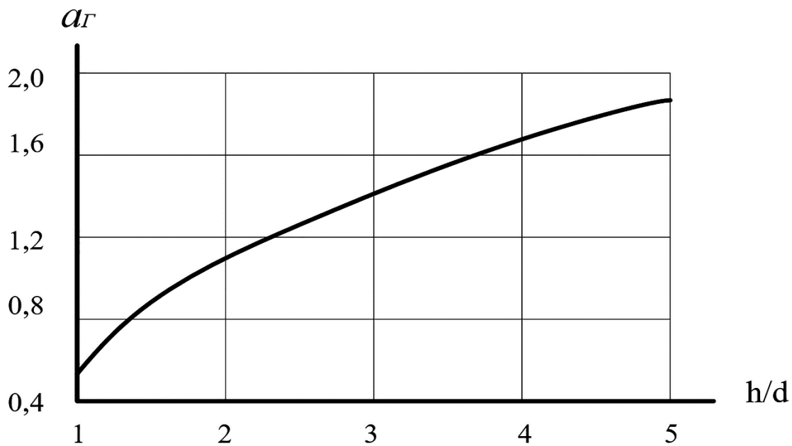
Рисунок 4.2 – Зависимость коэффициента, учитывающего геометрию нагревателя, от соотношения \frac{h}{d}
