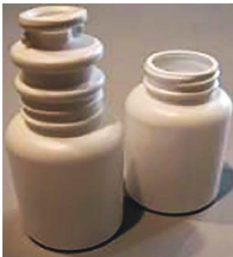
Рисунок 10 – Выдувная банка с облоем и без облоя
